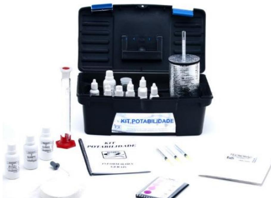
**Figura 10 – Kit de potabilidade utilizado para análise de parâmetros físico-químicos e microbiológicos**
