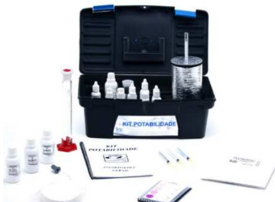
Figura 12 – Kit de potabilidade utilizado para análise de parâmetros físico-químicos e microbiológicos
