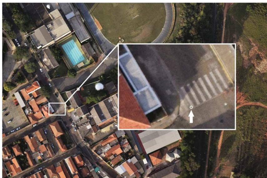
**Figura 9 – Ponto de controle artificial foto identificável**
