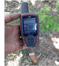
Aparelho GPS utilizado para marcação topográfica
