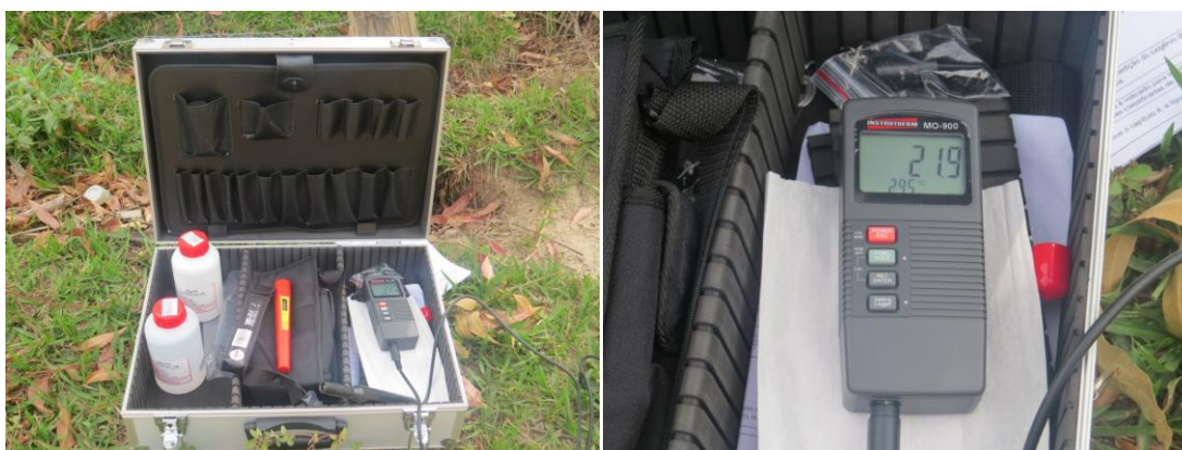
Figura 3: Equipamentos utilizados para análises de pH e oxigênio dissolvido realizadas em campo pelos técnicos da GOS Florestal.
