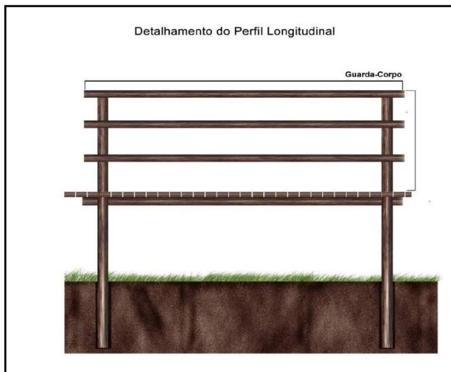
**Figura 6 - Detalhamento do guarda-corpo.**
